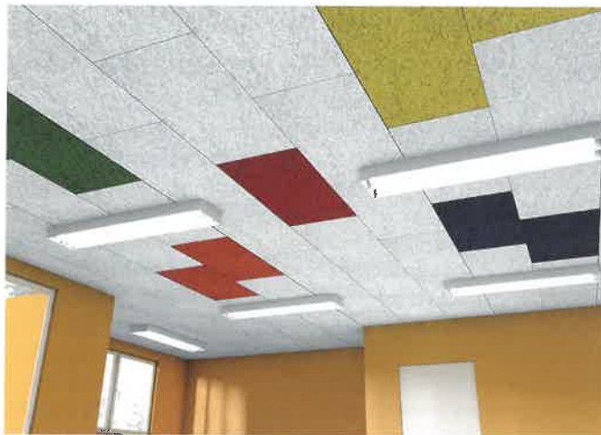
Bild 5. Der nahezu fotorealisticer 3D-Designentwurf der neuen Akustikdecke wurde vom Computerspiel Tetris inspiriert (Fotos/Grafik: Fibrolith Dämmstoffe GmbH)
